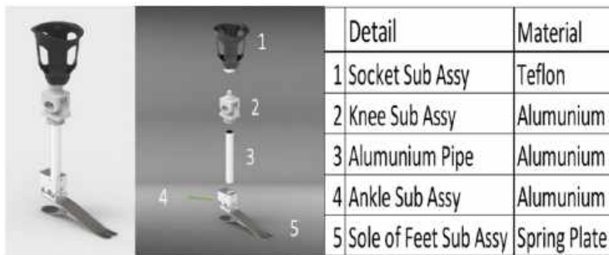
Gambar 42. 3D CAD Model Kaki Tiruan Atas Lutut (KTAL)
