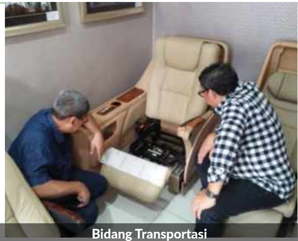
Gambar 47. Rancang Bangun Prototyping Kursi kelas Executive Pada Kereta Premium
