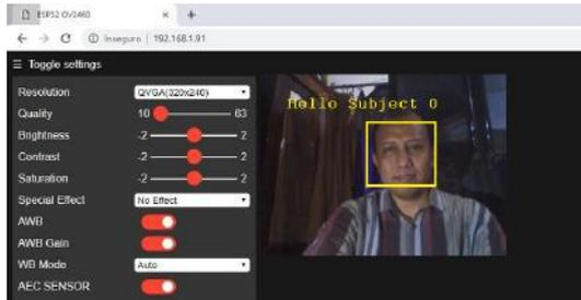
Gambar 3.8. Tes ESP32CAM
