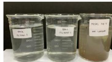
Gambar 12. Perbedaan Air Limbah Setelah Penyaringan ke-1(tengah) dan 2 (kiri) Menggunakan Prototipe IV.
