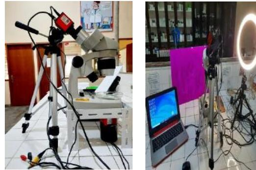
Gambar 1. Hasil Alat Modifikasi Mikroskop *Dissecting* ditambah Kamera CCTV merek HD camera
