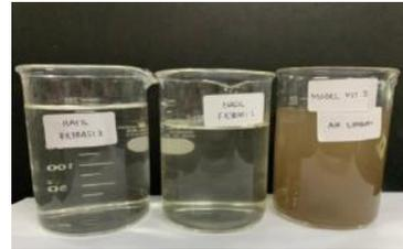
Gambar 11. Perbedaan Air Limbah Setelah Penyaringan ke-1(tengah) dan 2 (kiri) Menggunakan Prototipe III.
