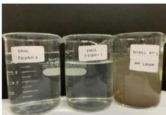
Gambar 10. Perbedaan Air Limbah Setelah Penyaringan ke-1(tengah) dan 2 (kiri) Menggunakan Prototipe II.
