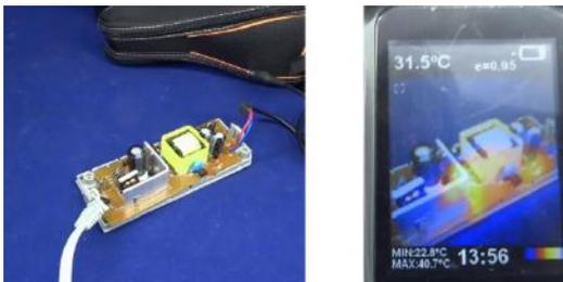
Gambar 3.5. Sebuah rangkaian catu daya yang diamati menggunakan kamera termal HT-02
