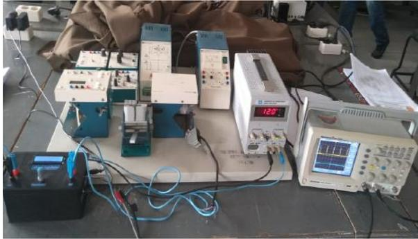
**Gambar 11. Pengujian buck boost converter dengan beban motor DC**
