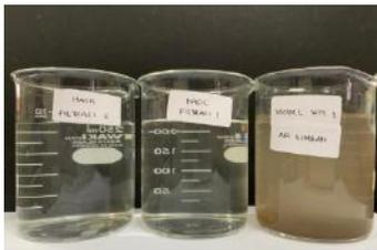
Gambar 9. Perbedaan Air Limbah Setelah Penyaringan ke-1(tengah) dan 2 (kiri).
