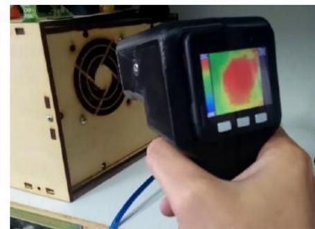
Gambar 3.2. Purwarupa yang digunakan untuk memeriksa jalur ventilasi yang mengeluarkan panas dari dalam suatu peralatan elektronik.
