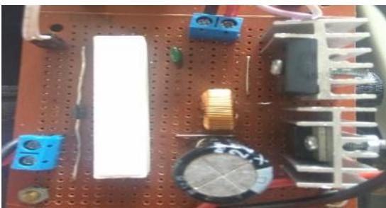
**Gambar 9.** Bentuk implementasi *buck boost converter*
