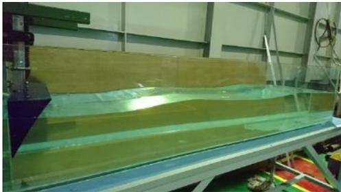
Gambar 6 . Pengujian pembangkit gelombang reguler
