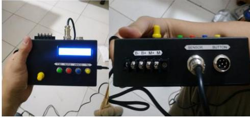
Gambar 5 . Instrumen kontrol kecepatan putaran motor
