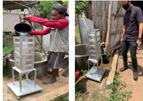
Gambar 8. Proses Pengujian Kebocoran Alat
