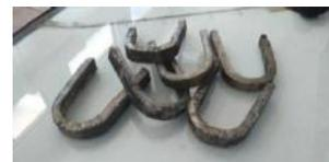
Gambar 10 : Hasil Uji Bending
