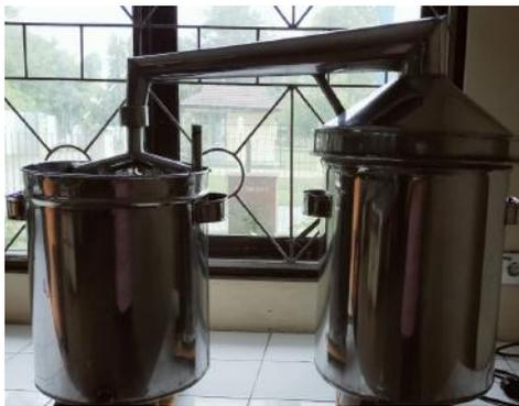
**Gambar 2.** Ketel destilasi uap setelah dimodifikasi
